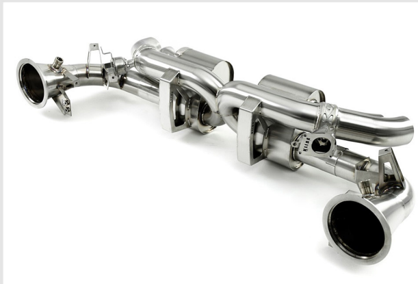
Выхлоп ( Inconel ) - Глушитель с заслонками Valvetronic
