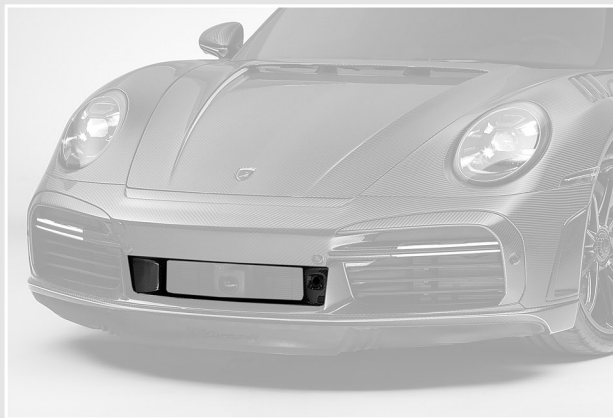
2. Центральный воздуховод переднего бампера
